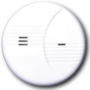
Der JA-60SP ist ein optischer Rauchmelder nach dem Streulichtprinzip, welcher nach dem Erkennen von Rauch sein Alarmsignal drahtlos an die Zentrale sendet.
